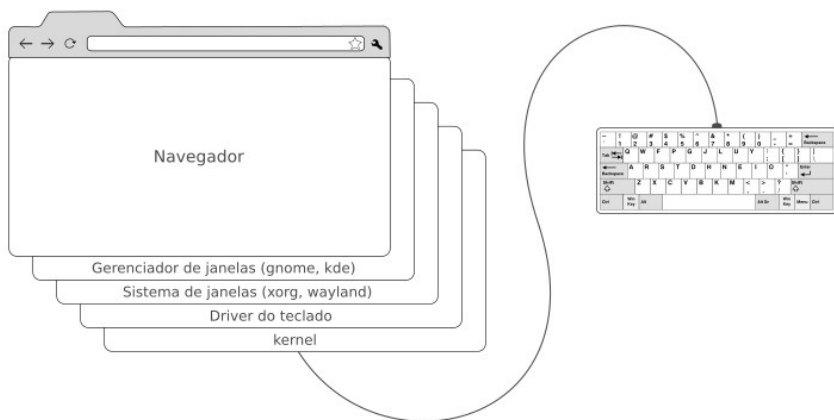
Figura 1.2: Exemplo das várias camadas entre o teclado e o navegador em um sistema GNU/Linux
